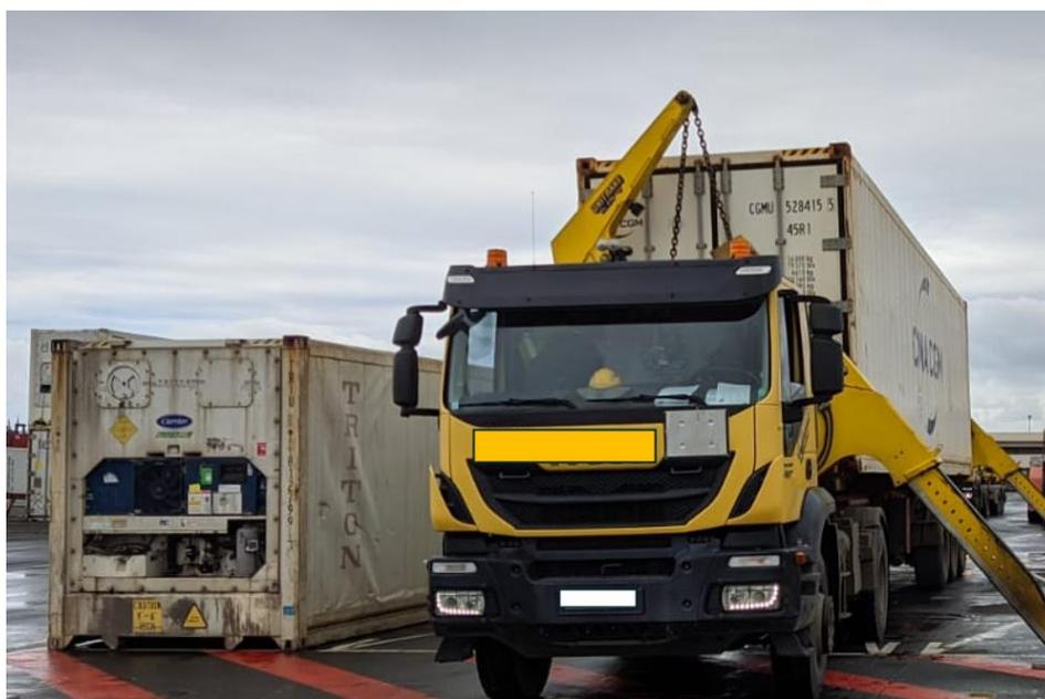
Figure 26 : Exemple de poids lourd chargeant ou déchargeant les containers sur la zone du PANC
