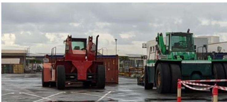
Figure 25 : Exemples d'engins de levage de type « Stacker » sur la zone du PANC
