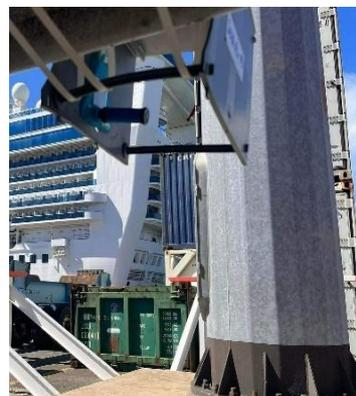
Figure 1: Dispositif de mesures passives du  $\text{SO}_2$  par tube Radiello 166
